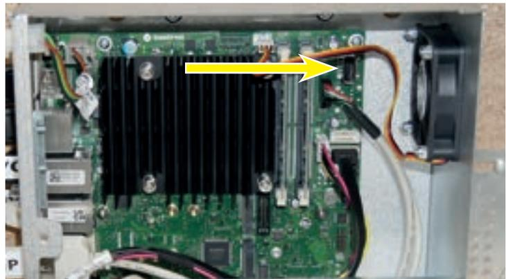
5. Stecken Sie den vorbereiteten Update-Stick in die USB-Buchse auf der Steuereinheit.
