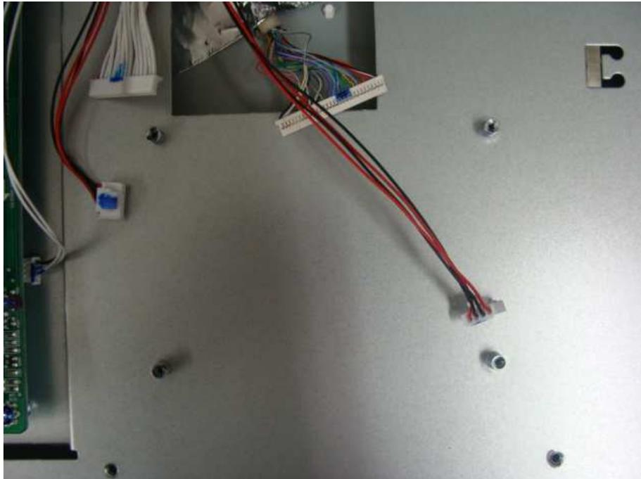
Montieren sie die 4 Schrauben und verbinden sie die Kabel wie sie sie entfernt haben.
