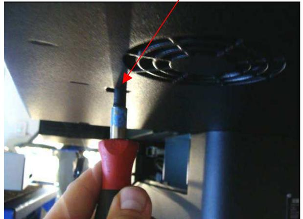
2.1.6 Entfernen sie nun die 8 Schrauben um das Display zu entnehmen.
