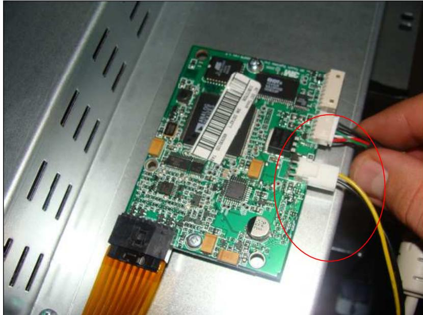
2.1.8 Entfernen sie die Abdeckung des Display um an das OSD Board zu kommen.
